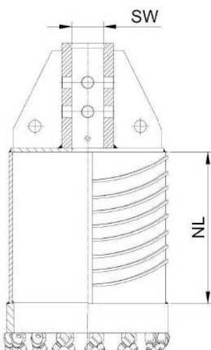
KEHD ( se zapuštěnými pouzdry pro výměnné nože )
